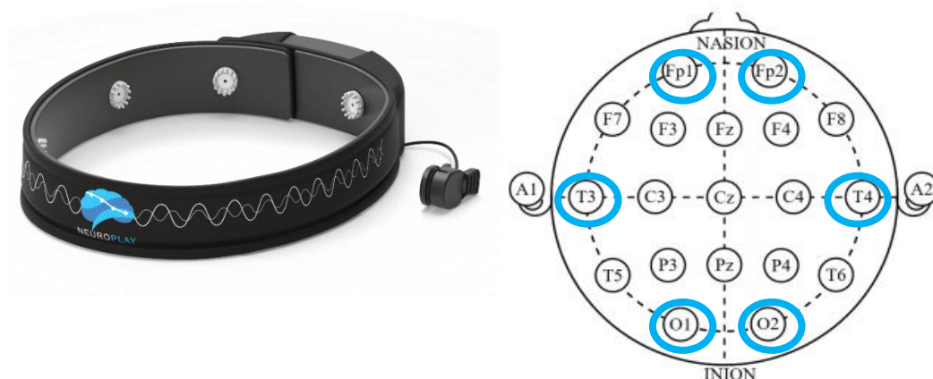
Рис. 5. Слева – внешний вид NeuroPlay-6C, справа - Международная схема расположения электродов «10-20»
